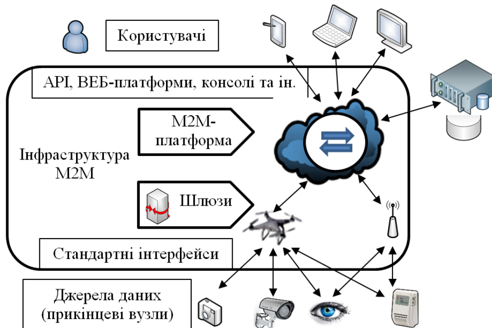
Рис. 1. Структура всепроникаючої мережі із застосуванням технологій М2М та БПЛА.
