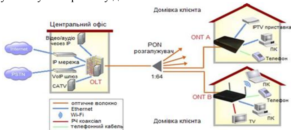
Рис. 2 Застосування GPON ONT в жилomu приміщенні клієнта.
