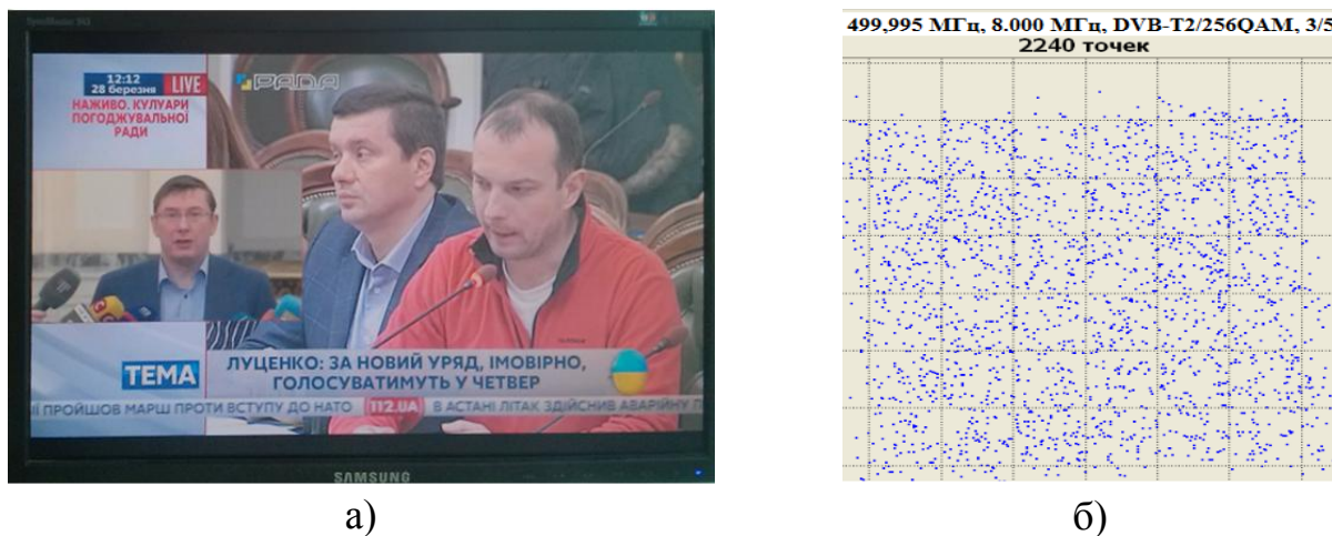
Рис. 3. Зображення ТВ сигналу стандарту DVB-T2 на екрані ПК (а), та сигнальне сузір'я на приймальному кінці (б).
