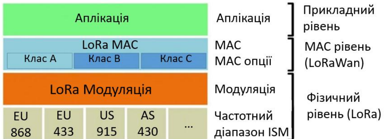
Рис. 1. Стек протоколу LoRaWAN.
