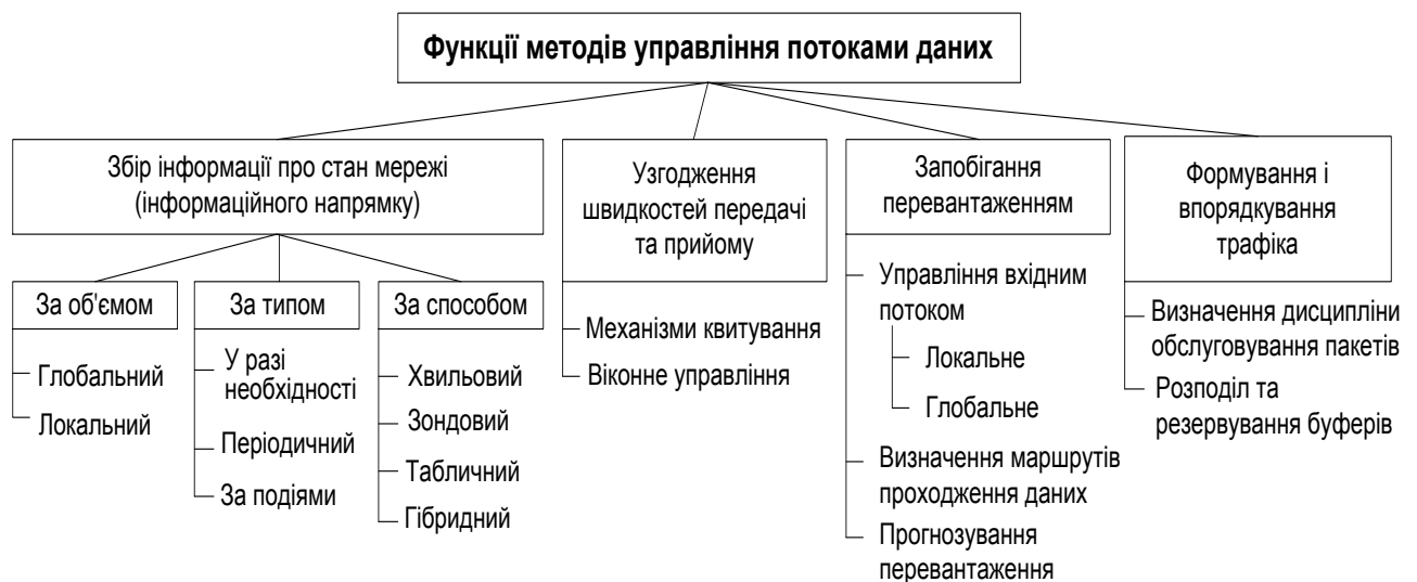
Рис. 1. Функції методів управління потоками даних в безпроводових самоорганізуючих мережах.
