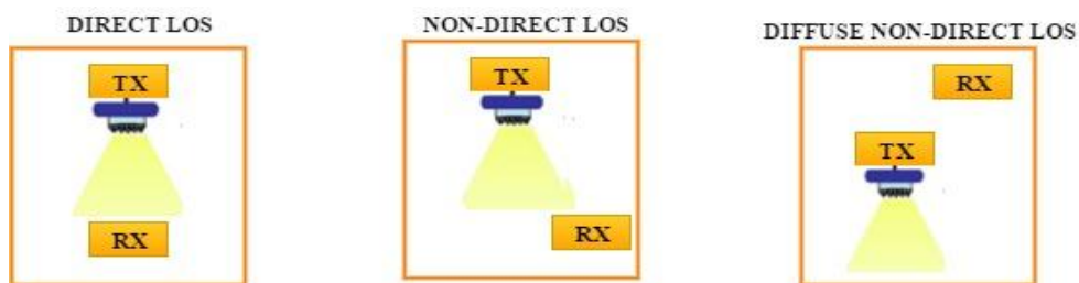
Рис. 2. Зображення трьох можливих типів топологій: спрямована VLC лінія (LOS - directed Line-of-Sight), не спрямована VLC лінія (non-directed LOS) та дифузна VLC лінія (diffused non-LOS).
