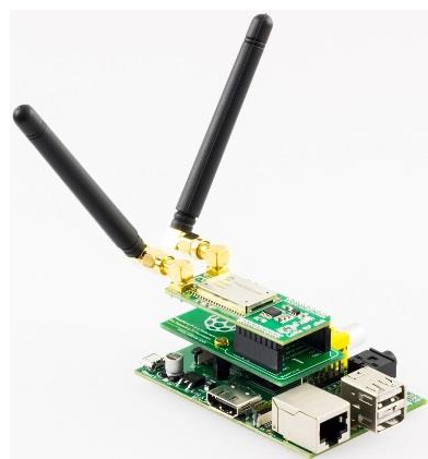
Рис.4 Шлюз для LoRa на Raspberry Pi (а) і LoRa Shield для Arduino (б).
