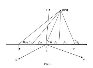
ИРИ по плоскому направления  $\theta$ фронту ЭМВ, изложенному проанализируем возможности устранения неоднозначности ДЛЯ AP. эквидистантой линейной ИЗ M+1состоящей приемных элементов (рис.1), которые находятся друг от друга на расстоянии половины средней длины волны  $\lambda/2$  рабочего диапазона системы с АР в случае определения дальности R до ИРИ по кривизне фронта ЭМВ.
