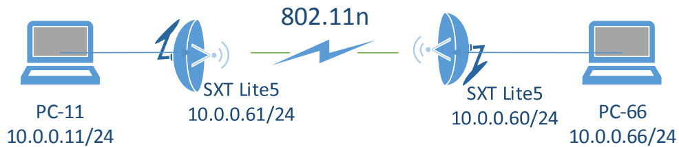
Рис. 1. Исследуемая сеть вида точка-точка на основе оборудования 802.11n
