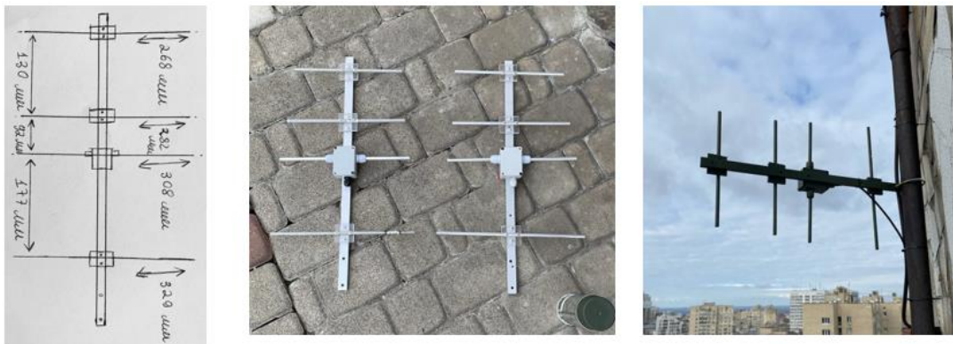
Рис.3. Виготовлення і встановлення антен радіомосту.
