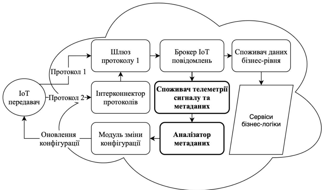
Рис.1. Адаптивна мультипротокольна архітектура IoT системи (AMISA).
