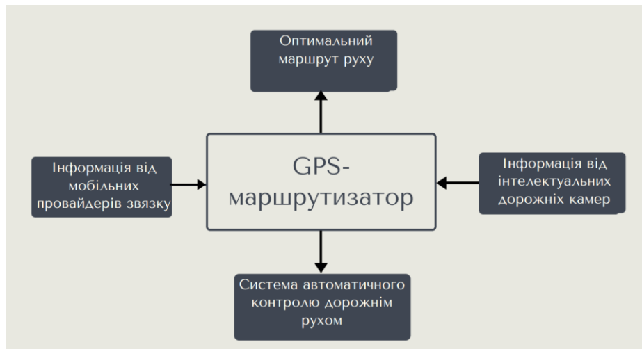
Рис. 3. Принципова схема роботи GPS-маршрутизатора.
