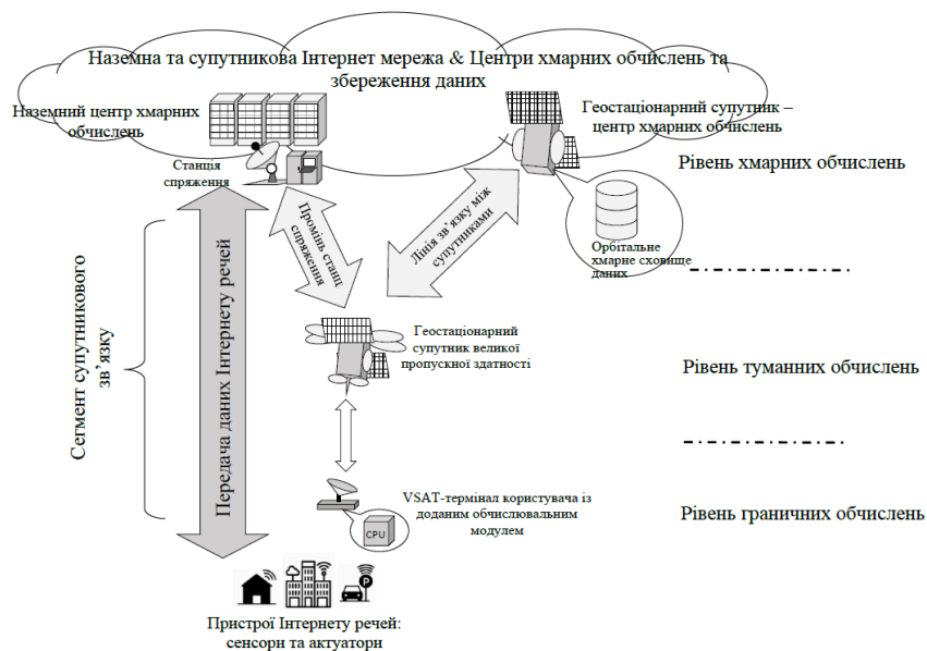
Рис.1. Ієрархічна модель геостационарної супутникової системи Інтернету речей.
