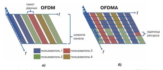
Рис. 2. Один пользователь, использующий канал с использованием OFDM (a) и мультиплексирование различных пользователей в одном канале с использованием OFDMA (б)
